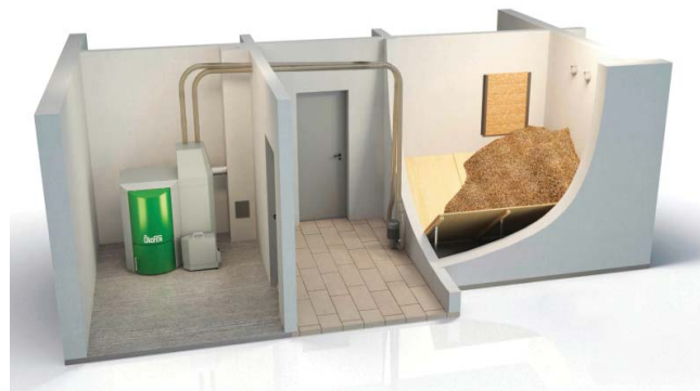
Skizze Pelletheizkessel, Brennstoffzuführung, Schrägbodenlager
