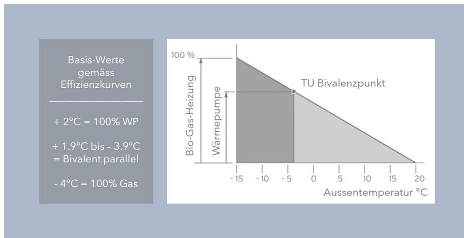
Im Zusammenhang mit den neuen Energieverordnungsgesetzen in den Kantonen werden hybride Heizsysteme weiter an Bedeutung zunehmen. Zurzeit werden in der Regel Einzelsysteme modular mit einer intelligenten Steuerung zusammen geführt. Wichtig ist, dass die Hybrid-Steuerung alle Betriebszustände abbilden kann und die Kommunikation zwischen den Einzelmodulen jederzeit sicher gestellt wird. In diesem Zusammenhang empfiehlt sich, sämtliche hybride Komponenten von einem Hersteller einzusetzen.
